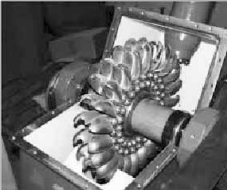
Fig. 2: interno di Turbina Pelton, con in evidenza le pale a doppio cucchiaio della girante.
