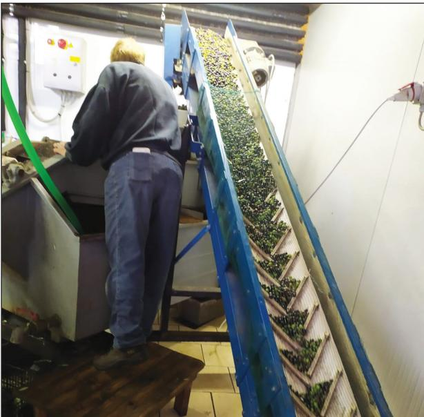
Elevatore a nastro durante il trasporto delle olive nel frantoio.
