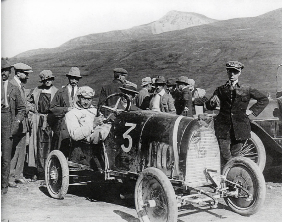
Una vettura da corsa preparata dai Fratelli Temperino. Da notare nella parte anteriore l'avvamento "a calcio"
